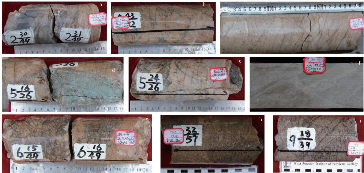
图7 玉北3井及玉北1井部分岩心段上的多期裂隙、缝洞充填特征
